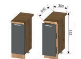
Корпус: ШНБ 300 (ШхВхГ): 300x706x430 мм Фасад: ШНБ 300 (ШхВхГ): 296x703x16 мм (1 шт.)
