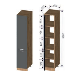
Корпус: ПН2-400 (ШхВхГ): 400x2036x550 мм Фасад: ПН2-400 (ШхВхГ): 396x1326x16 мм (1 шт.), 396x703x16 мм (1 шт.)
