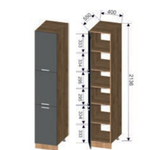
Корпус: ПН-400 (ШхВхГ): 400x2036x550 мм Фасад: ПН-400 (ШхВхГ): 396x703x16 мм (2 шт.), 396x618x16 мм (1 шт.)
