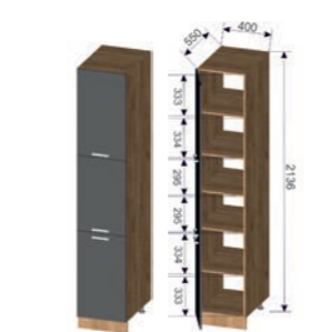
Корпус: ПН-400 (ШхВхГ): 400x2036x550 мм Фасад: ПН-400 (ШхВхГ): 396x703x16 мм (2 шт.), 396x618x16 мм (1 шт.)
