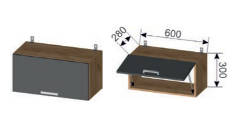
Корпус: ШГ 600 (ШхВхГ): 600x300x280 мм Фасад: ШГ 600 (ШхВхГ): 596x296x16 мм (1 шт.)
