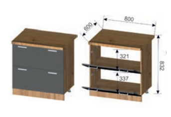
Корпус: ШНГ 800 (ШхВхГ): 800x706x430 мм Фасад: ШНГ 800 (ШхВхГ): 796x350x16 мм (2 шт.)
