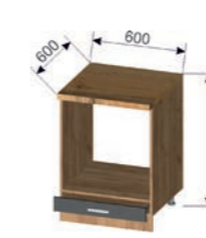
Корпус: ШНДЯ 600 (ШхВхГ): 600x706x550 мм Фасад: ШНДЯ 600 596x100x16 мм (1 шт.)
