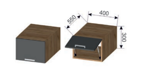
Корпус: ШАН 400 (ШхВхГ): 400x300x550 мм Фасад: ШАН 400 (ШхВхГ): 396x296x16 мм (1 шт.)
