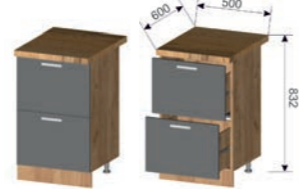
Корпус: ШН2А 500 (ШхВхГ): 500x706x430 мм Фасад: ШН2А 500 (ШхВхГ): 496x350x16 мм (2 шт.)
