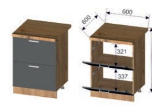
Корпус: ШНГ 600 (ШхВхГ): 600x706x430 мм Фасад: ШНГ 600 (ШхВхГ): 596x350x16 мм (2 шт.)
