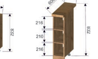
Корпус: ШНДЯ 600 (ШхВхГ): 600x706x550 мм Фасад: ШНДЯ 600 596x100x16 мм (1 шт.)
