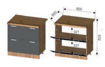
Корпус: ШНГ 800 (ШхВхГ): 800x706x430 мм Фасад: ШНГ 800 (ШхВхГ): 796x350x16 мм (2 шт.)
