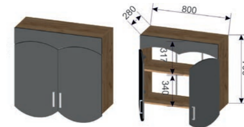
Корпус: ШВ 800 (ШхВхГ): 800x705x280 мм Фасад: ШВ 800 (ШхВхГ): 796x132x16 (1 шт.), 396x700x16 (2 шт.)
