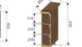
Корпус: ШНДЯ 600 (ШхВхГ): 600x706x550 мм Фасад: ШНДЯ 600 596x100x16 мм (1 шт.)
