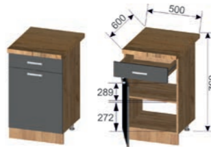
Корпус: ШН1Я 500 (ШхВхГ): 500x706x430 мм Фасад: ШН1Я 500 (ШхВхГ): 496x137x16 мм (1 шт.), 496x560x16 мм (1 шт.)
