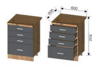
Корпус: ШНЯ 600 (ШхВхГ): 600x806x550 мм Фасад: ШНЯ 600 (ШхВхГ): 596x137x16 мм (3 шт.), 596x278x16 мм (1 шт.)
