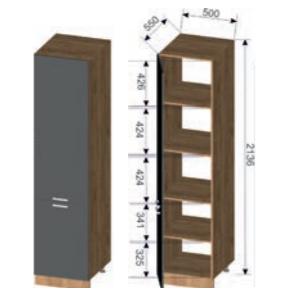
Корпус: ПН2-500 (ШхВхГ): 500x2036x550 мм Фасад: ПН2-500 (ШхВхГ): 496x1326x16 мм (1 шт.), 496x703x16 мм (1 шт.)
