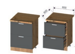
Корпус: ШНСА 600 (ШхВхГ): 600x706x430 мм Фасад: ШНСА 600 (ШхВхГ): 596x350x16 мм (2 шт.)
