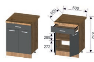
Корпус: ШН1А 600 (ШхВхГ): 600x706x430 мм Фасад: ШН1А 600 (ШхВхГ): 596x137x16 мм (1 шт.), 296x560x16 мм (2 шт.)
