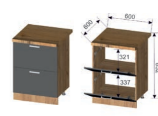
Корпус: ШНГ 600 (ШхВхГ): 600x706x430 мм Фасад: ШНГ 600 (ШхВхГ): 596x350x16 мм (2 шт.)
