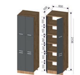
Корпус: ПН-600 (ШхВхГ): 600x2036x550 мм Фасад: ПН-600 (ШхВхГ): 296x703x16 мм (4 шт.), 296x618x16 мм (2 шт.)
