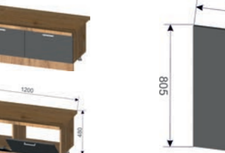
Корпус: ШНТВ 1200 (ШхВхГ): 1200x354x430 мм Фасад: ШНТВ 1200 (ШхВхГ): 596x350x16 мм (2 шт.)
