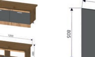
Корпус: ШНТВ 1200 (ШхВхГ): 1200x354x430 мм Фасад: ШНТВ 1200 (ШхВхГ): 596x350x16 мм (2 шт.)
