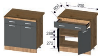
Корпус: ШН1А 800 (ШхВхГ): 800x706x430 мм Фасад: ШН1А 800 (ШхВхГ): 796x137x16 мм (1 шт.), 396x560x16 мм (2 шт.)
