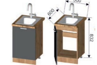
Корпус: ШНМ 500 (ШхВхГ): 500x706x430 мм Фасад: ШНМ 500 (ШхВхГ): 496x703x16 мм (1 шт.)
