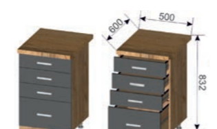
Корпус: ШНЯ 500 (ШхВхГ): 500x706x430 мм Фасад: ШНЯ 500 (ШхВхГ): 496x137x16 мм (3 шт.), 496x278x16 мм (1 шт.)
