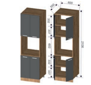
Корпус: ШВД-600 (ШхВхГ): 600x2036x550 мм Фасад: ШВД-600 (ШхВхГ): 296x703x16 мм (4 шт.)
