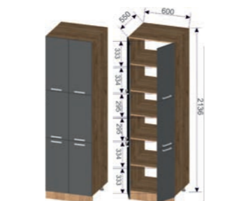
Корпус: ПН-600 (ШхВхГ): 600x2036x550 мм Фасад: ПН-600 (ШхВхГ): 296x703x16 мм (4 шт.), 296x618x16 мм (2 шт.)
