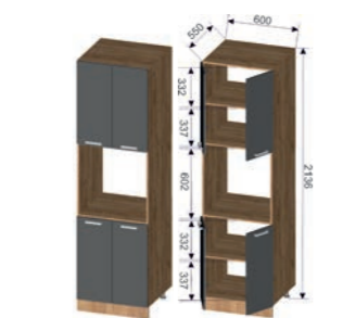
Корпус: ШВД-600 (ШхВхГ): 600x2036x550 мм Фасад: ШВД-600 (ШхВхГ): 296x703x16 мм (4 шт.)
